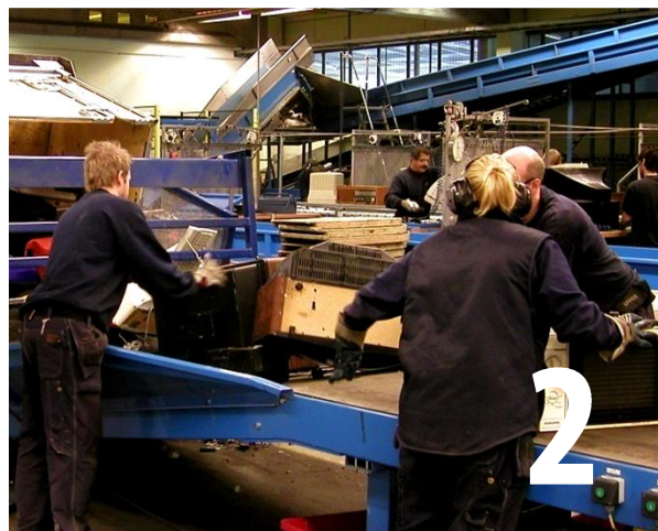
Tömning av elektronikavfall, ut på en bred bandtransportör, för en första grovsortering.
