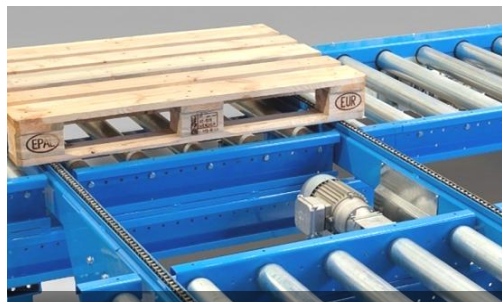
Pallrullbana med integrerad kedjeväxel
